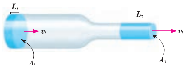
شکل ۳-۲۹ در یک شاره تراکم‌ناپذیر، مقدار شاره‌ای که در زمان t از سطح مقطع A_1 می‌گذرد درست برابر مقدار شاره‌ای است که در همین زمان از سطح مقطع A_2 می‌گذرد.
